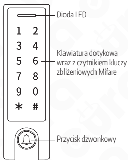
Rys. 2. Budowa zamka szyfrowego AC-90H4
